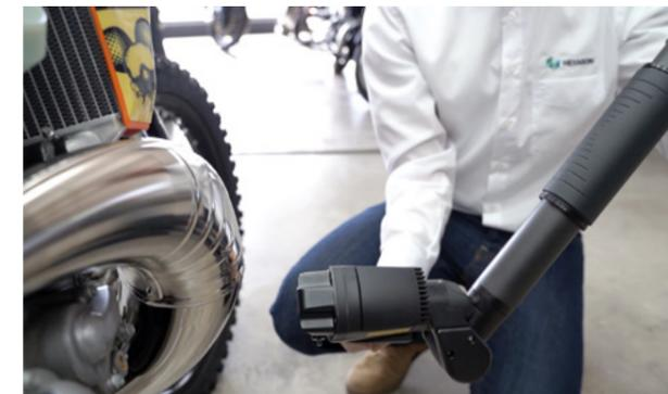
Digitalizado 3D con el brazo Absolute Arm y el software REcreate de Hexagon para el proceso de ingeniería inversa
