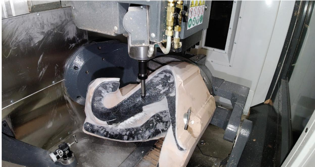
Mecanizado 5 ejes simultáneos programado y simulado con el software CAM WORKNC de Hexagon
