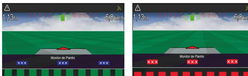
Figura - Monitor de plantio modo avançado densidade
