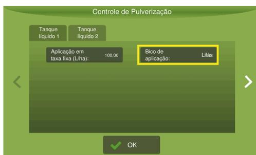
Figura - Configuração de bico
