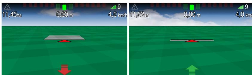
Figura - Detector de ré na operação
