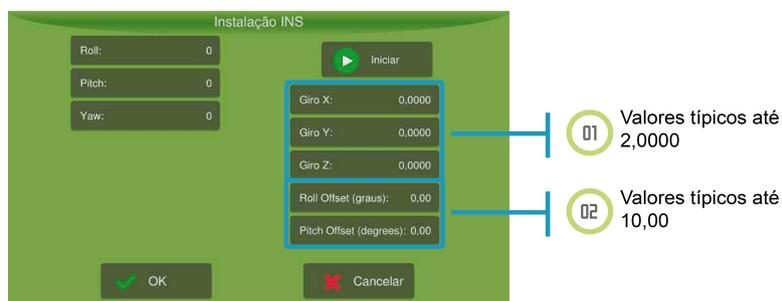
Figura - Instalação do INS
