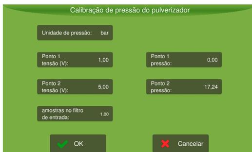
Figura - Calibração de leitura de pressão
