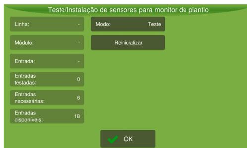
Figura - Teste instalação de sensores de plantio modo teste
