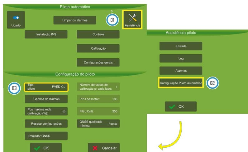
Figuras - Configurando o tipo de piloto
