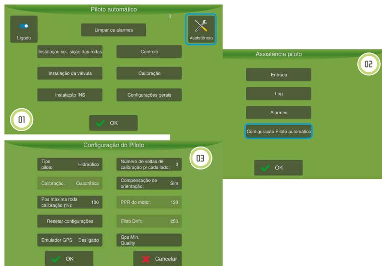
Figura - Assistência e configuração de piloto
