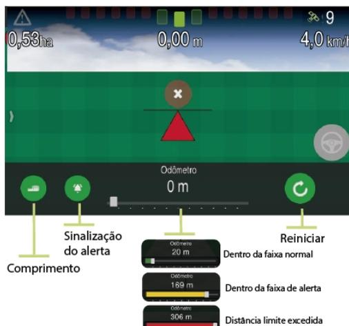
Figura - Operação do Controle de fertilização
