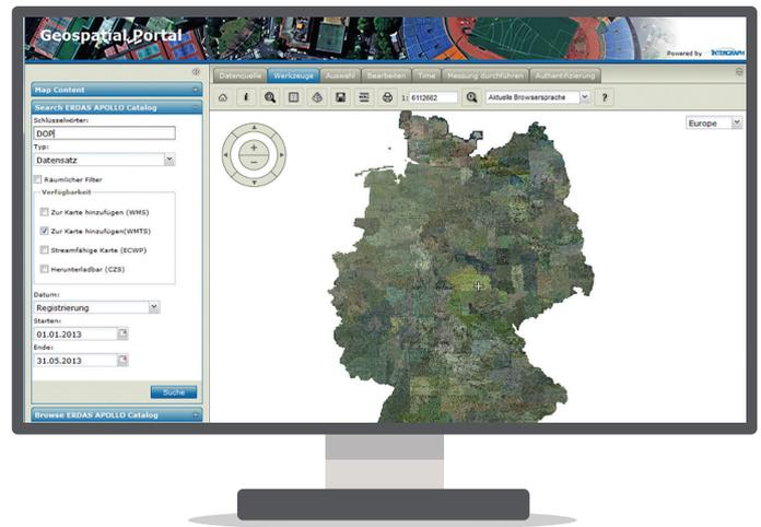
Diese Ansicht zeigt das ECW-Bild (1 Terabyte), das im Geospatial Portal läuft. Der ECWP Streaming Service wird von ERDAS APOLLO Essentials zur Verfügung gestellt und ist wesentlich schneller als Standard Open Geospatial Consortium (OGC®) Services. Er funktioniert sogar in Netzwerken mit geringer Bandbreite. Das unkomprimierte Bildmaterial umfasste 38 Terabyte. © BKG (2011) powered by Hexagon.
