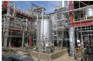
現地調査で注意した点は、調査対象プラント設備が危険物を取り扱っている化学工場であった事からガス検知器で安全性を確認しながら計測を実施しました。またマルチショットの計測位置や基準位置を現地入りする前に図面上で検討しました。
