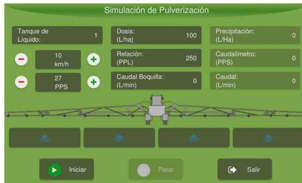
Figura - Simulación del pulverizador
