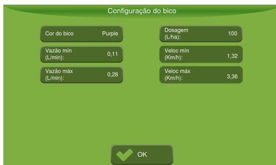
Figura - Configuración del pico
