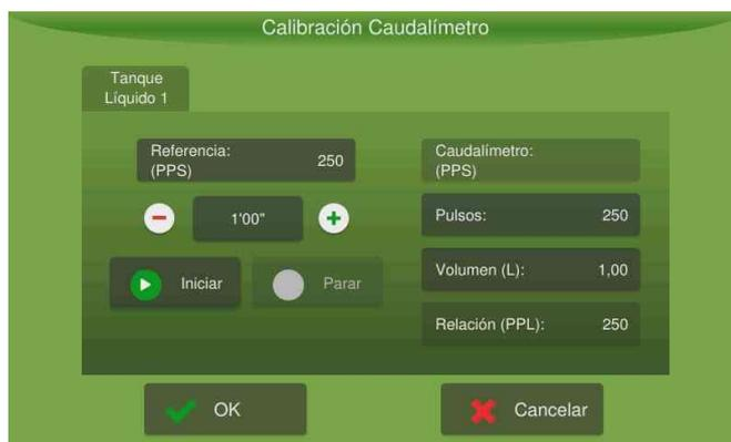
Figura - Calibración del caudalímetro
