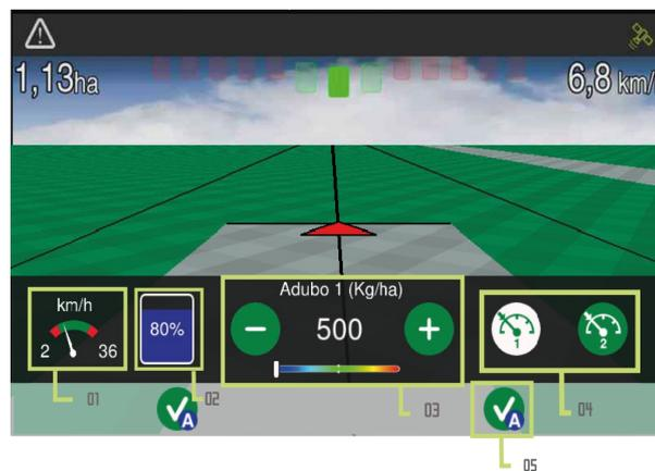
Figura - Control de fertilización
