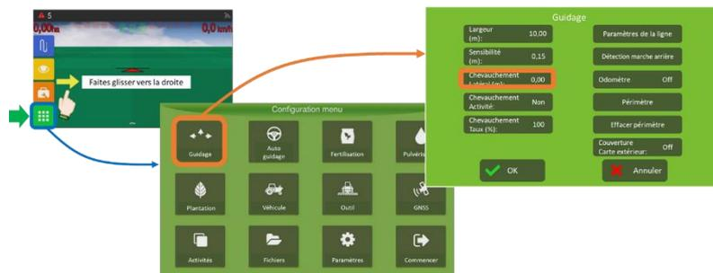
Indique la valeur en (m) du chevauchement. Ce paramètre est utilisé avec des outils de type « pulvérisateur ».
