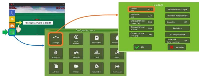
Indique la largeur de travail en (m) entre passages. Sa valeur provient de l'outil sélectionné (voir « [Créer un nouveau travail en mode conventionnel](#) »), ou de la largeur entrée dans le mode rapide (voir « [Créer un nouveau travail en mode rapide](#) »).
