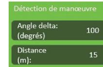
**Détection de manœuvre** : ces paramètres affectent la façon dont le système détecte que le véhicule a effectué un mouvement en U pour sortir d'une ligne et entrez dans une autre. Ceci permet aussi de déterminer automatiquement les modifications du guidage en mode courbe adaptative (voir aussi « Guidage en ligne courbe adaptative » en page 47).
