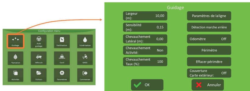
**Largeur de travail** (m): 10,00 : indique la largeur de travail en (m) entre passages. Sa valeur provient de l'outil sélectionné (voir « Créer un nouveau travail en mode conventionnel » en page 33, ou de la largeur entrée dans le mode rapide (voir « Créer un nouveau travail en mode rapide » en page 3).
