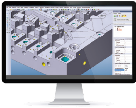
Construction de perçages avec gestionnaire de features & traitement FAO automatique
